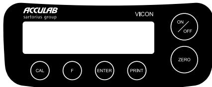
**(ON/OFF)** Marche/Arrêt : met la balance sous tension, l'éteint ou la met en mode de veille.
