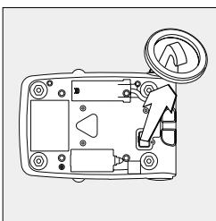
Para los pesajes por debajo de la balanza existe un dispositivo en la base de la balanza.
