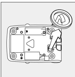
Un dispositif de pesée en dessous du socle est à votre disposition pour toutes vos pesées sous le socle de la balance.
