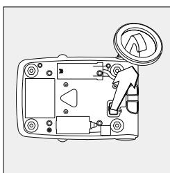
Für Wägungen unterhalb der Waage steht eine Unterflurwägungseinrichtung zur Verfügung.
